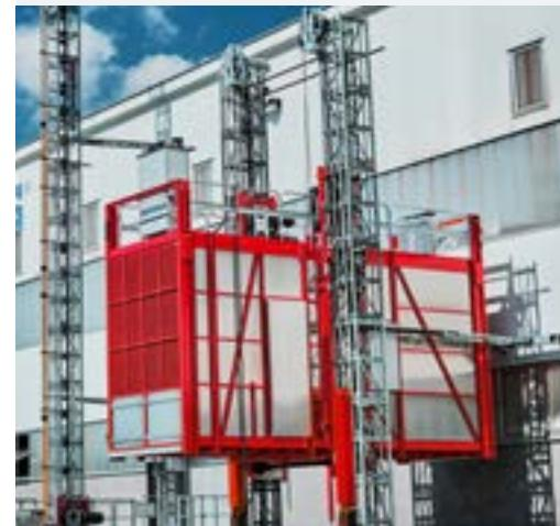
Les ascenseurs industriels NOV sont construits pour les environnements difficiles et le fonctionnement fiable dans divers bâtiments industriels, comme, par ex., les centrales électriques, cimenteries, fabriques de chaux, dépôts de charbon, aciéries, raffineries, mines.
